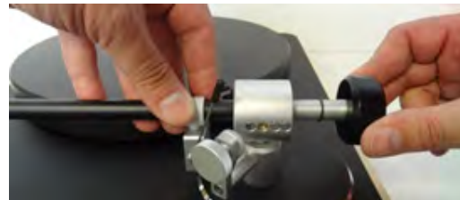
Abb. 2: Montieren des Gegengewichts
