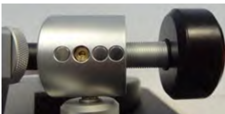
Abb. 3: Endgültige Position des Gegengewichts
