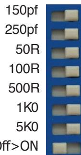
Abb. 2.2: Starteinstellung (150 pf - 5K0 „OFF“, Subsonic „OFF“)
