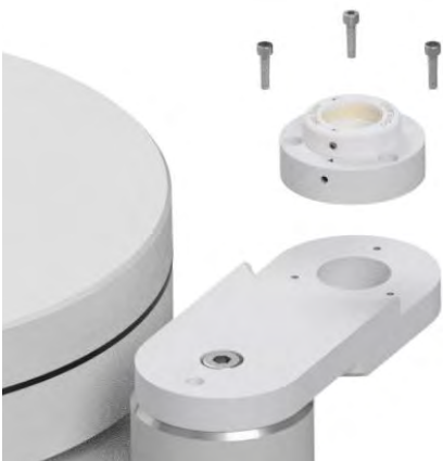
Abb. 11: Montage des Klemmrings
