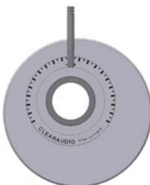
Abb. 7: Montage des VTA-Lifters auf die Champion Basis
