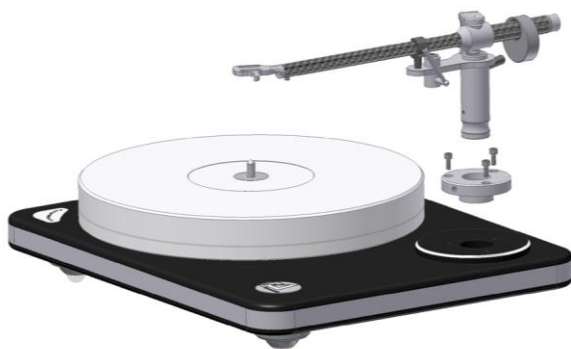
Abb. 2: Befestigung des Klemmrings
